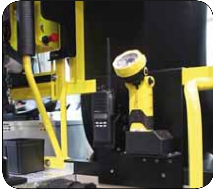
CV.1000.24V, Artikel-Nr. B69-7013-A, Ladegerät und Leuchte im Fahrzeug verbaut.
